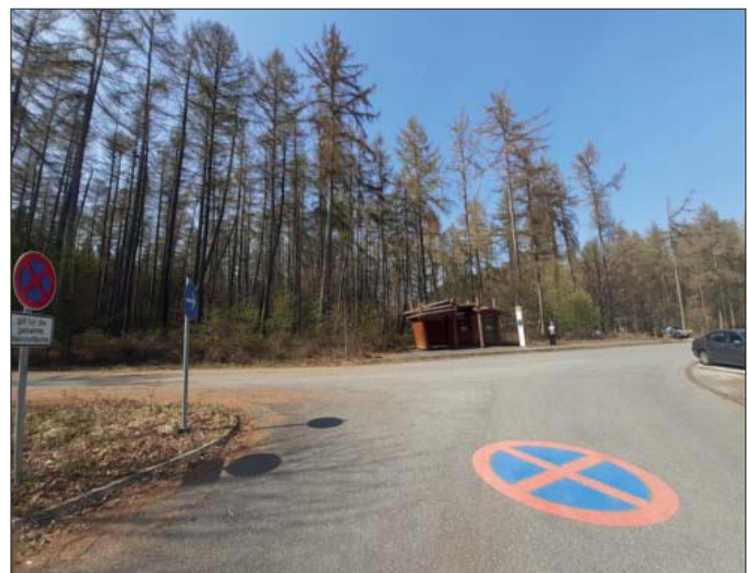
Parkplatz Wilder Kermeter: Nach der Aufbringung von zusätzlichen Halteverbotszeichen auf den Asphalt an der Buswendeschleife nahm unzulässiges, den Busverkehr behinderndes Parken deutlich ab.
