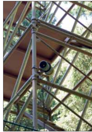
Abbildung 86: Fledermaus-Mikrofone am Forschungsturm erfassen Fledermaus-Aktivitäten in unterschiedlichen Höhen (Foto: Andreas Pardey)
