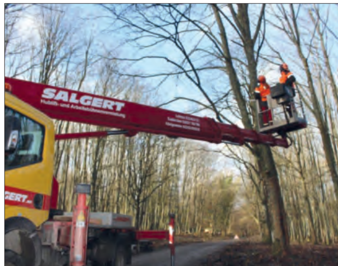
Verkehrssicherungsarbeiten Kermeter: In den Baumwipfeln lässt es sich nur mit Hubsteiger arbeiten.
