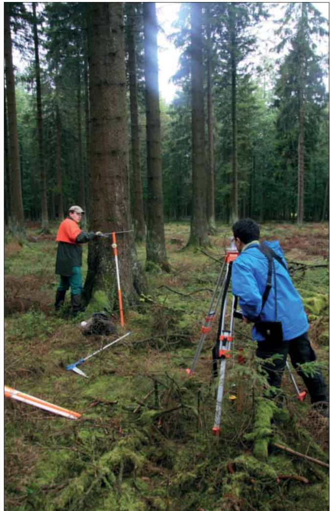
Abbildung 25: Waldstrukturaufnahme in einem Stichprobenkreis (hier: Koordinate stehender Baum und Durchmesser).
