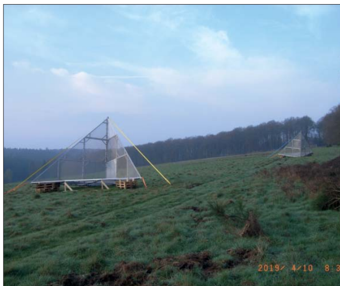
ESA-Projekt TomoSense: Reflektoren auf der Amselplei zur Positionierung und Kalibrierung der Radar-Befliegungsdaten.
